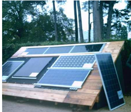
Démonstration des différentes technologies de module photovoltaïque
