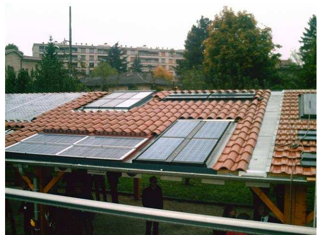
Plate-forme photovoltaïque pour la pose des modules
