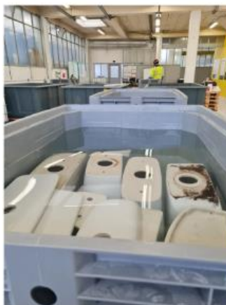
2 lignes de trempage de soude et acide (fabriqués sur place par electrolyse)
