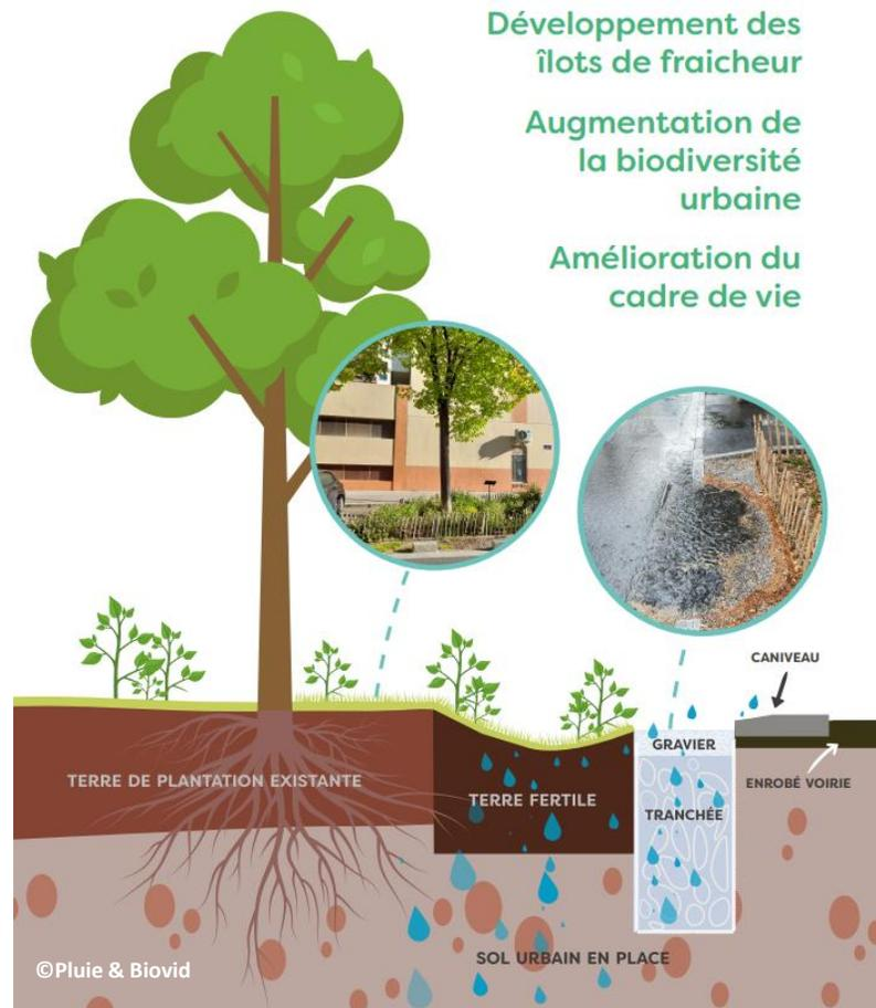
Schéma des arbres de pluie : Une Solution d'Adaptation Fondée sur la Nature, SAFN. Adapté du livret technique du GLYON
