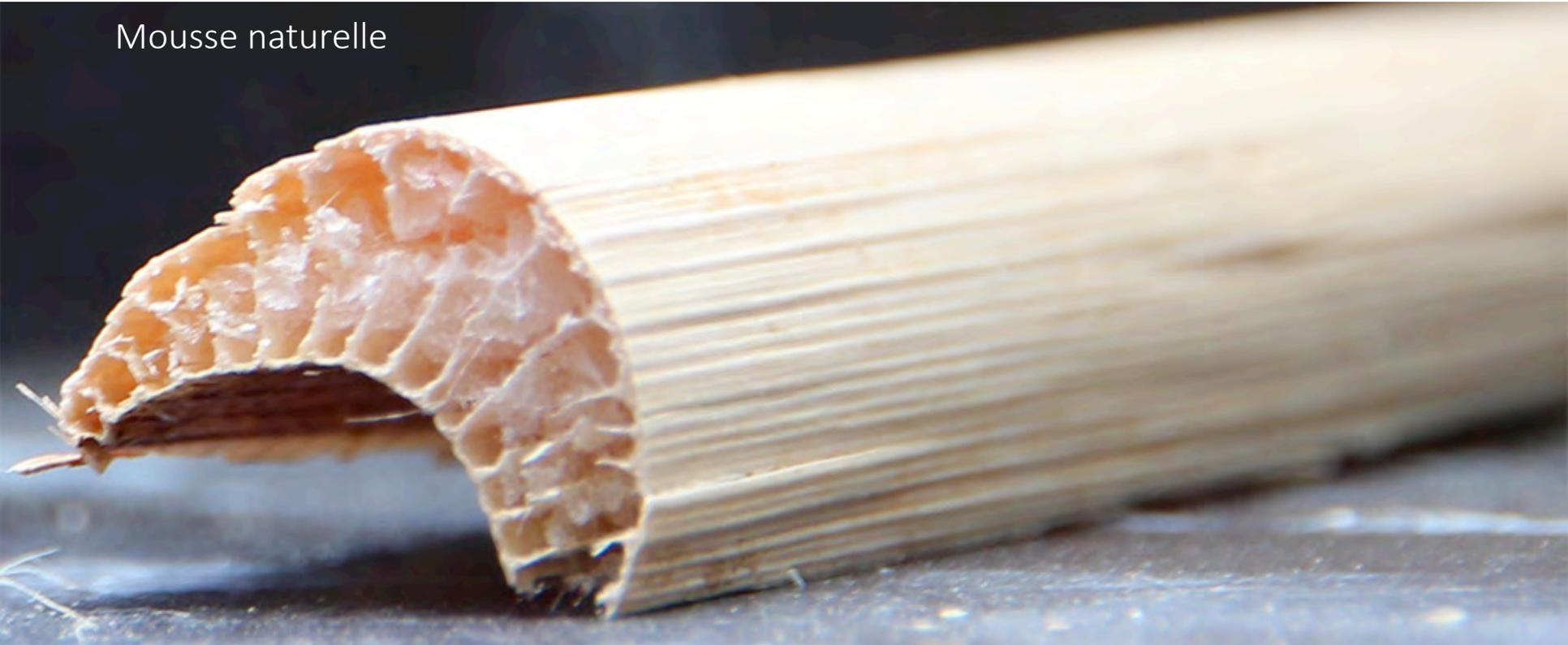
Structure alvéolaire poreuse
