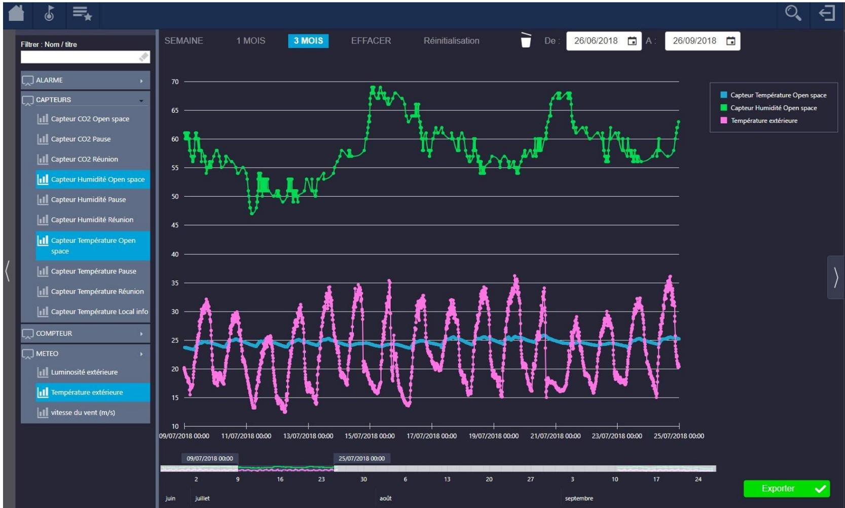
Extrait monitoring du 9/07/18 au 25/07/18: gain de température 9 à 10 c° sans climatisation
