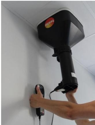
*Mesure du débit des bouches d'extraction avec un cône avec anémomètre à moulinet déporté*
