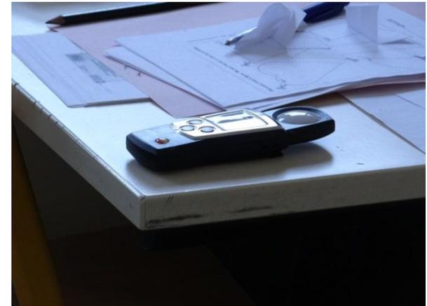
*Mesure d'éclairage avec un luxmètre*
