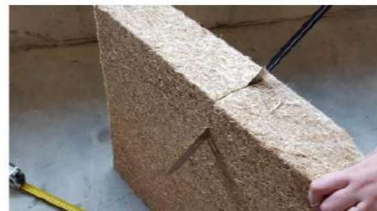
**Présentation et mise en œuvre d'isolant biosourcé en paille de riz de Camargue par FBT Isolation**
