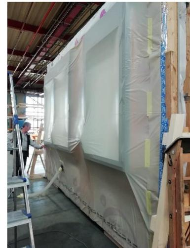
*Test de perméabilité à l'air des murs ossature bois en usine*
