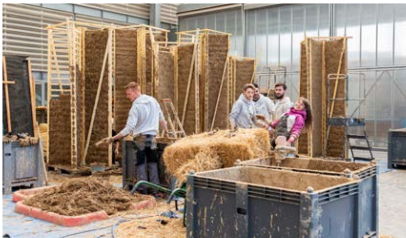
Préfabrication des panneaux terre (@ Lauriane Lespinasse)
