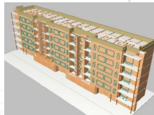
*IFC2x3 issu de Cypecad MEP et ouvert sous ArchiCAD*
