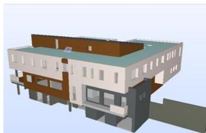
*Fusion de l'IFC du modèle de structure épuré avec le modèle d'ArchiCAD*
