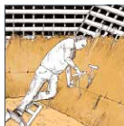
CHAQUE BARRÉ HORIZONTALE EST FIXÉE À LA TOITURE PAR UN FIL D'ACIER INOXYDABLE PASSÉ SANS LES LITTEAUX GRÉS AUX ANIMULES.
