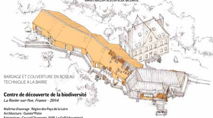
PAR RANGÉES SUCCESSIVES, LES BOTTES SONT POSEES SUR LE TOIT. LES TIGES DE ROSEAU SONT ÉTALÉES, FAÇONNÉES ET SÈCHÉES DANS DES LITTEAUX GRÉS AUX ANIMULES.
