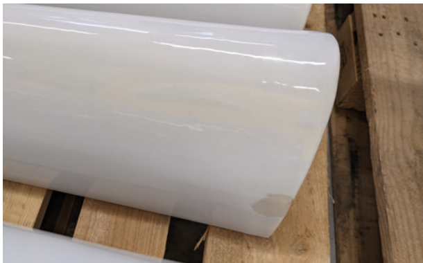
ECLATS DE CÉRAMIQUES (y compris sur les surfaces non visibles après pose)
