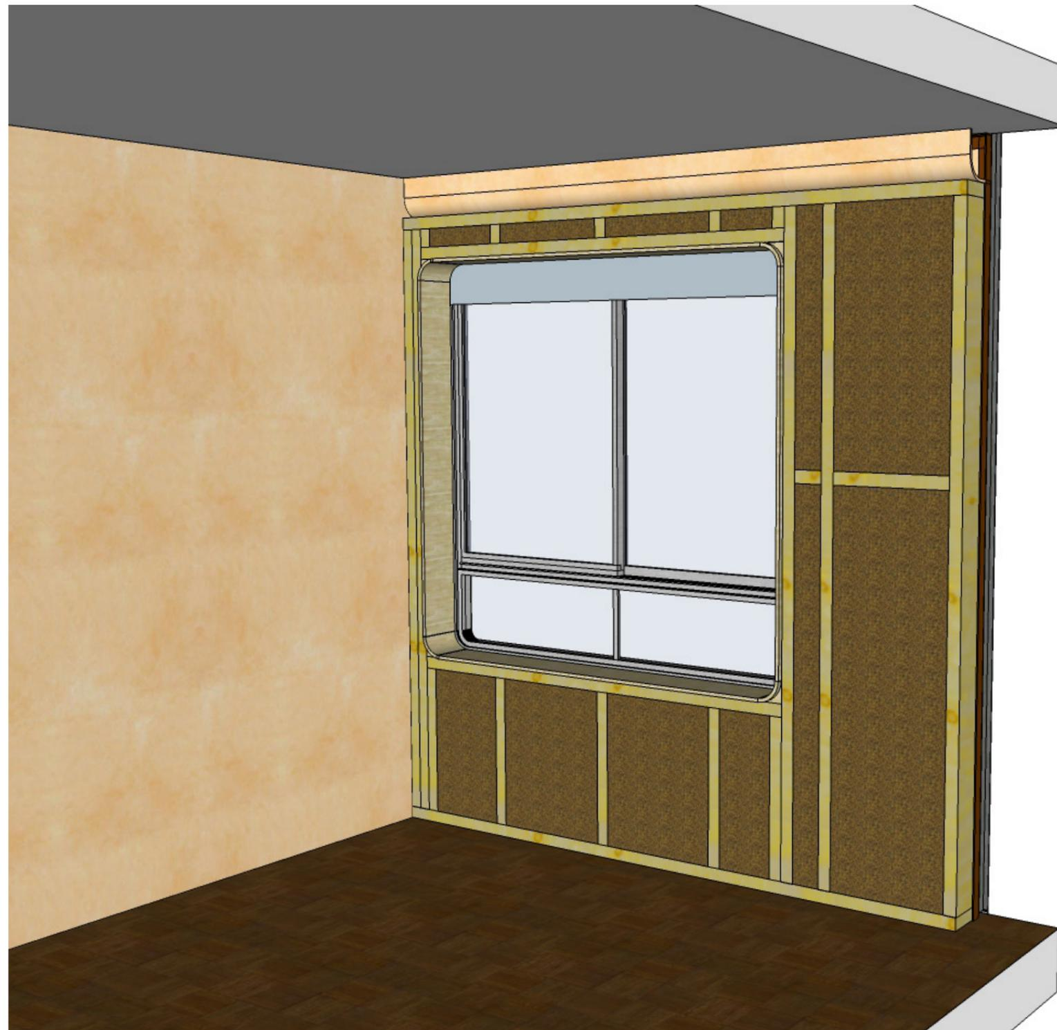
Installation de l'isolant fibre de bois et du frein-vapeur
