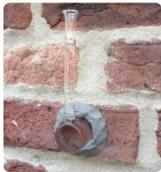
▲ La pipette de Karsten est un test simple pour estimer l'absorption d'eau des briques. Un tube de verre rempli d'eau est fixé de manière hermétique en surface de la brique. Une échelle graduée indique la quantité d'eau qui pénètre en un temps donné. © Plate-Forme Maison-Passive
