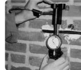
▲ Dans une certaine mesure, les contraintes de compression (et donc la résistance à la compression in situ) peuvent être estimées au moyen d'un vérin plot. Cette technique consiste à pratiquer une saignée dans la maçonnerie au niveau d'un joint de mortier horizontal afin d'y insérer un vérin plot mis sous pression.
