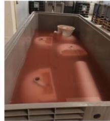
La céramique est alors **nettoyée et détartrée** dans des bains de soude et d'acide. Le joint silicone est retiré.
