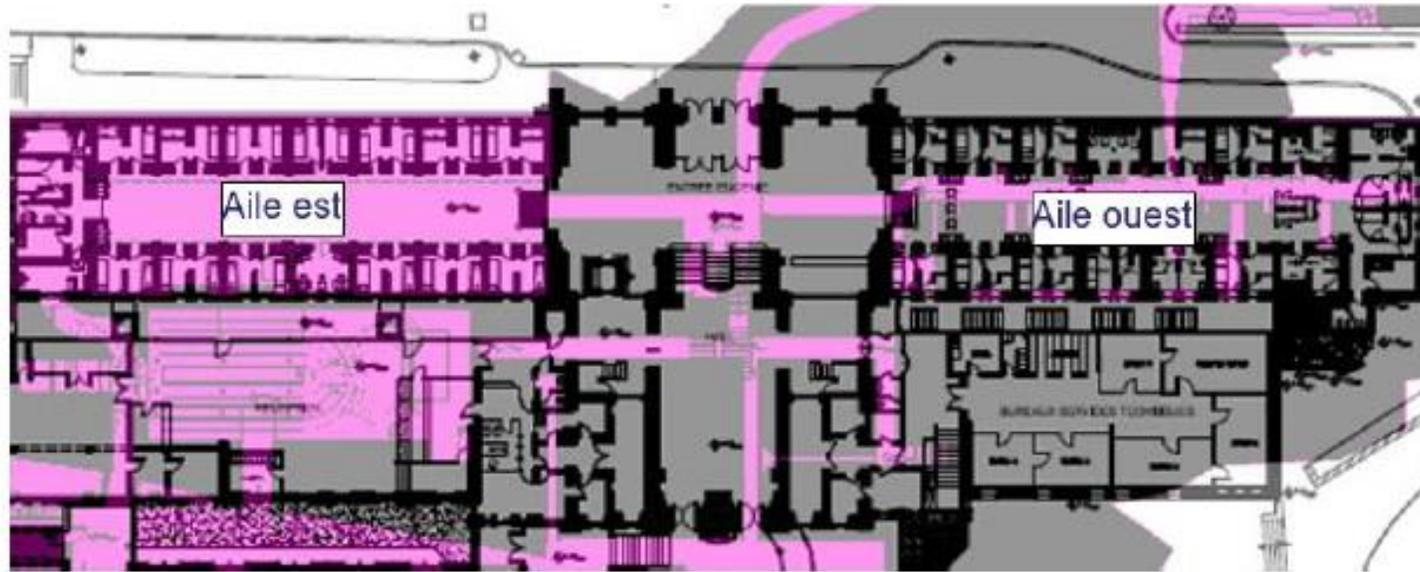
Figure 44 : situation des galeries souterraines et des sous-sols (en rose) par rapport au niveau 1 du bâtiment 1900 (en noir)
