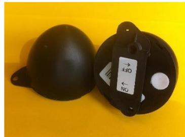
Dosimètre passif Radon
