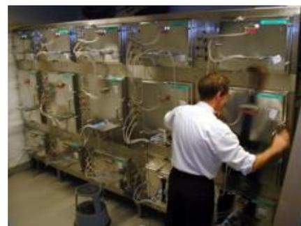
2 – Mise de l'échantillon en chambre d'essai
