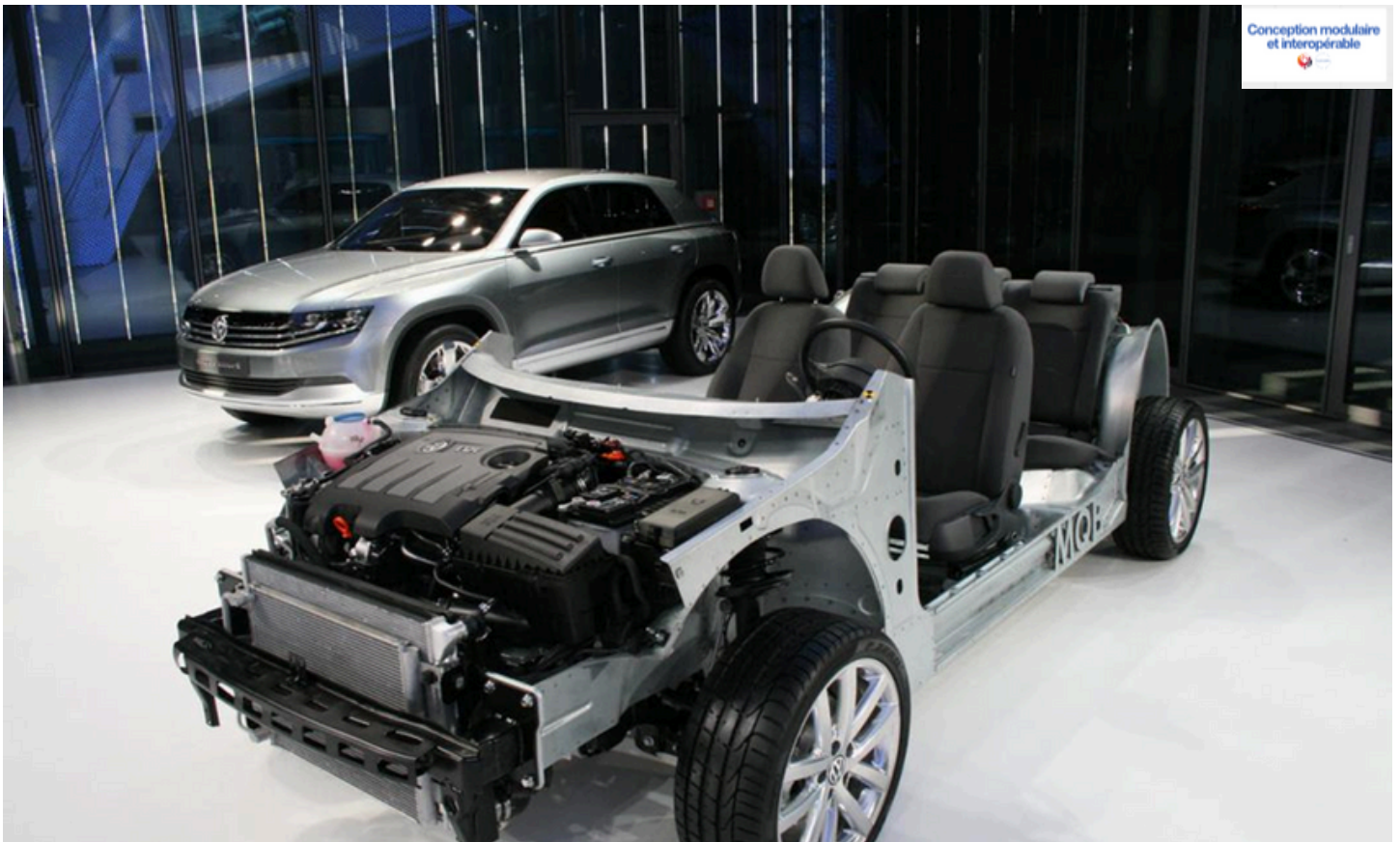
Plateforme MQB de Volkswagen de conception modulaire des véhicules. Le système MQB permet une réduction de 20% des coûts industriels et une augmentation de la productivité de 30% et ouvre à une possible récupération et réutilisation des pièces pour les nouvelles générations de voiture- Crédits : L'argus
