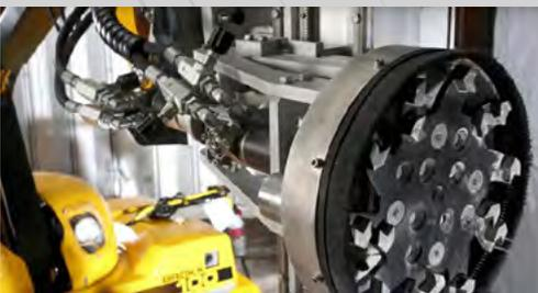
Positionné dans son environnement XYZ, le robot réalise des tâches de précision, optimise ses déplacements et ses passes de ponçage en évitant les zones indiquées.
